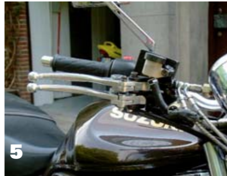
1 Schalten mit dem grünen Knopf. 2 Stützräder des »Feetless Bike System«. 3 Kupplung nach rechts gelegt. 4 Pneumatische Schaltung. 5 Fußbremse am Lenker. 6+7 Baustelle Rückfahrhilfe: Der Elektromotor treibt das Rad über Zahnriemen an, das Holz wird die Schablone für die Fräse. 8 Elektromagnetische Schaltung, Bedienung per Hand. 9 Fersenbremse. 10 Elektropneumatische Schaltung an einem BMW-Gespann. 11 Bremse, Kupplung und Gas – alles links. 12 Rückfahrhilfe über Extra-Ritzel. 13 Stellmotor.
