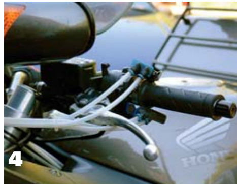
1 Schalten mit dem grünen Knopf. 2 Stützräder des »Feetless Bike System«. 3 Kupplung nach rechts gelegt. 4 Pneumatische Schaltung. 5 Fußbremse am Lenker. 6+7 Baustelle Rückfahrhilfe: Der Elektromotor treibt das Rad über Zahnriemen an, das Holz wird die Schablone für die Fräse. 8 Elektromagnetische Schaltung, Bedienung per Hand. 9 Fersenbremse. 10 Elektropneumatische Schaltung an einem BMW-Gespann. 11 Bremse, Kupplung und Gas – alles links. 12 Rückfahrhilfe über Extra-Ritzel. 13 Stellmotor.
