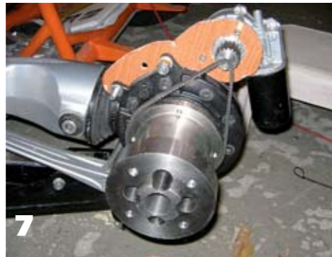
1 Schalten mit dem grünen Knopf. 2 Stützräder des »Feetless Bike System«. 3 Kupplung nach rechts gelegt. 4 Pneumatische Schaltung. 5 Fußbremse am Lenker. 6+7 Baustelle Rückfahrhilfe: Der Elektromotor treibt das Rad über Zahnriemen an, das Holz wird die Schablone für die Fräse. 8 Elektromagnetische Schaltung, Bedienung per Hand. 9 Fersenbremse. 10 Elektropneumatische Schaltung an einem BMW-Gespann. 11 Bremse, Kupplung und Gas – alles links. 12 Rückfahrhilfe über Extra-Ritzel. 13 Stellmotor.
