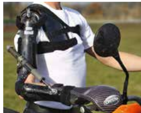
Medium: Der Zylinder nimmt die Kräfte auf und leitet sie dosiert an die Schulter weiter
