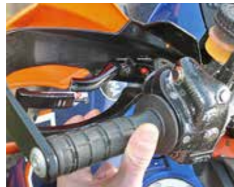
Kombi-Instrument: Der Bremshebel rückt beim Bremsen auch die Kupplung aus
