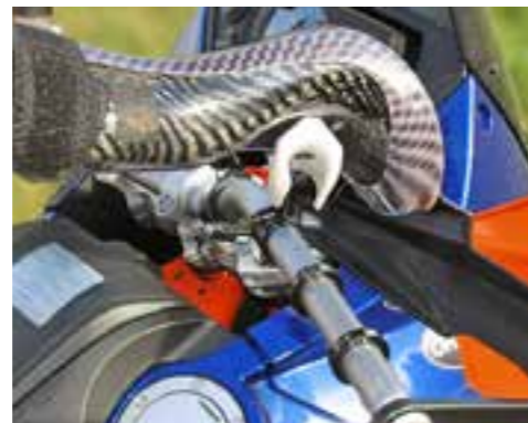
Klick: Die Prothese wird mit einem Kunststoffteil an den Lenker geklickt
