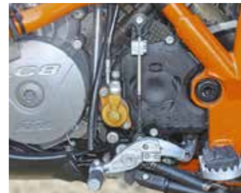
Heimarbeit: Der Schaltassistent an der KTM stammt aus Bernd Brands Werkstatt
